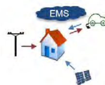
➔ Vehicle-to-home (V2H) Optimisation de la demande, Autoconsommation individuelle, Smart charging
