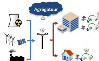
➔ Vehicle-to-grid (V2G) Services système, flexibilité, réserve de capacité
